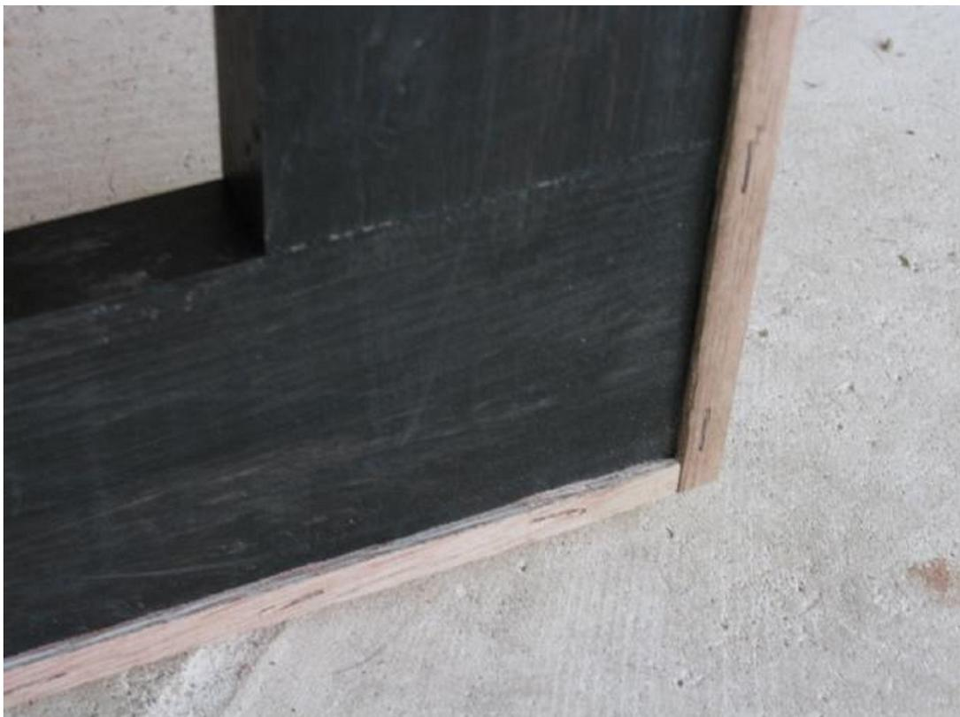
Cette baguette en contreplaqué de 13 mm de large environ et de 3 mm d'épaisseur va permettre de décoller la toile du cadre. De cette manière on évite que certaines arêtes se voient très légèrement avec un œil rasant. Et pis c'est encore plus mieux transonore puisque le son passe aussi devant les montants verticaux... M'enfin bon là je chipote et je ne demanderai pas de test en aveugle ! 🍷
